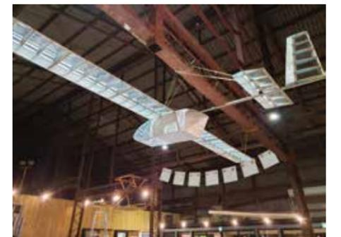
実際の大きさの模型。幅は20m。極力省スペースでできるように、組み立て式にしている。パーツは最長でも3mくらい。主な材料はCFRPという軽くて丈夫なカーボン。1機作るのに70~80万円くらいかかるそうですが、仲良くしている企業からお下がりをもらってコストダウンしています。
